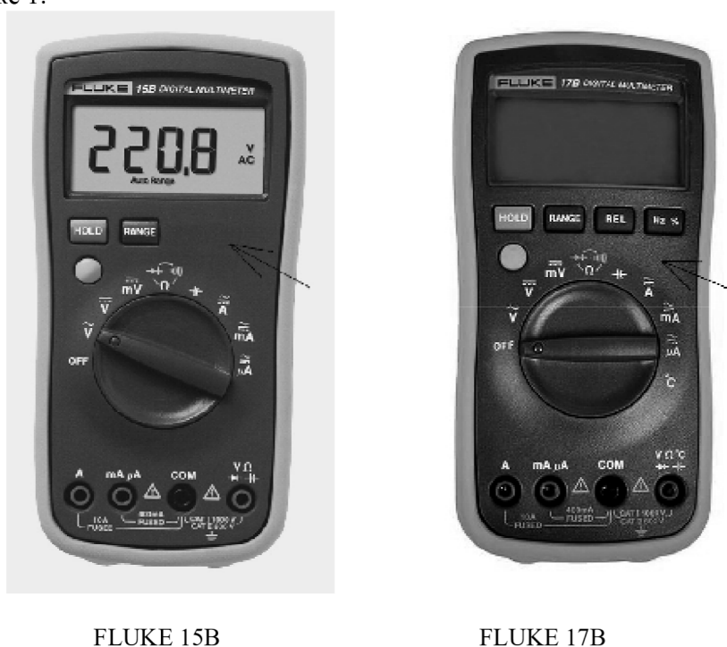
Рисунок 1 - Внешний вид мультиметров (стрелкой показано место нанесения знака утверждения типа)
